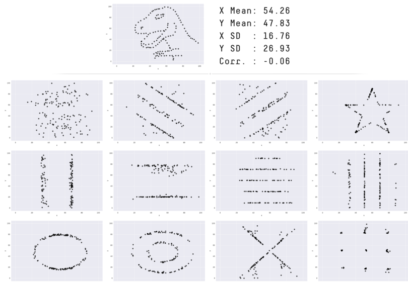
Abbildung A.3: The Datasaurus Dozen. Jeder Datensatz hat die gleichen statistischen Kenngrößen (Mittelwert, Standardabweichung, Pearson's Korrelation). Das Datasaurus Dozen wurde 2017 von Justin Matejka und George Fitzmaurice bei Autodesk Research entwickelt (Quelle: [43]).
